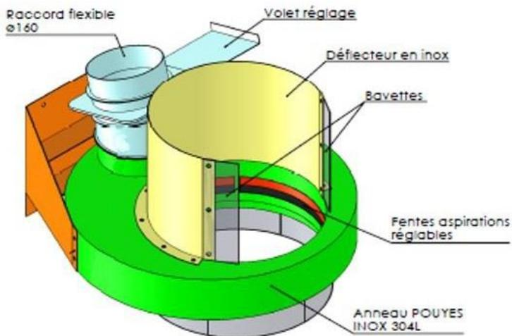
En laboratoire comme en production, toutes manipulations de pulvérulents ou de liquides engendrent systématiquement des émanations inconfortables, toxiques ou corrosives qu'il est indispensable de capter au plus près de leurs zones d'émission, afin d'en éviter les dommages sur le personnel et sur les équipements.
